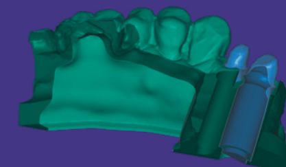
Полые модели допускают чрезвычайно экономически эффективную печать
